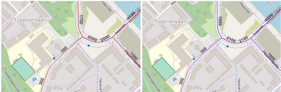
Kuva 5. Vasemmalla KAVL 2018 ja oikealla KAVL vuodelle 2040 ennustetut liikennemäärät (ei koululiikennettä mukana).
